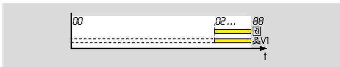
Параметр 15 = 1: проверка на источник постороннего излучения проводится без сигнала запуска (ϑ) (в течение так называемой позиции Готовность к работе/ Standby). Это позволяет быстрый запуск горелки и с этого момента время ожидания  $t_W$  отсутствует. Перед запуском горелка должна быть выключена по крайней мере на 4 с для того, чтобы проверка на источник постороннего излучения проводилась правильно.
