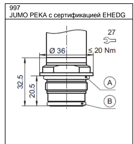
A Уплотнительное кольцо G B Кольцо круглого сечения 21x2,5
